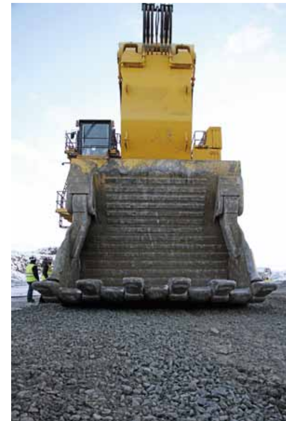
↑ PC8000 FS E pistokauhakoneen vakiokauhan koko on 42 kuutiometriä. Kevitsan raskaamman kivilaadun vuoksi käytössä on "ainoastaan" 36-kuutioinen kauha.
