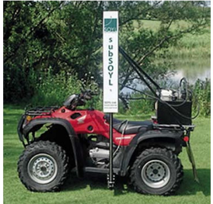
← ↑ Maaperän fysikaaliset ominaisuudet (kuten tiivistymät), tulevat koko ajan tärkeämmiksi. Tässä kartassa näkyy penetrometrinen vastus. Kartan punaiset kohdat vaatisivat kuohkeutusta. Mittalaite voidaan kiinnittää esimerkiksi mönkijään, kuten tässä SOYL-servicen tapauksessa.
