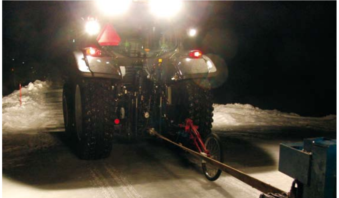
↑ Nastarenkaiden käyttöä voi lämpimästi suositella. Pitokyky lisääntyy mittaustemme mukaan jäällä noin 30 %. Rengasvertailussamme (KV 6/2011) mukana ollut nastoitettu Nokian TRI2-rengas oli myös ajotuntumaltaan ja sivuttaispidoltaan parempi kuin nastoitamaton rengas. Hintaa nastoitukselle kertyi 576 euroa.
