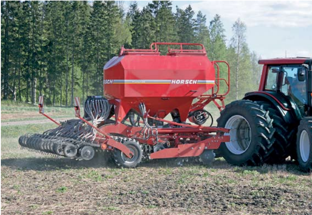
↑ Uusin tulokas Loimaan suorakylvökokeessa on saksalainen Horsch Pronto. Kone on neljän metrin etumuokkarilla varustettu puhallintoiminen suorakylvökone, jossa siemenet ja lannoitteet kylvetään eri vantaista. Kummatkin vantaat ovat kaksoiskiekkovantaita, ja siemenvantaissa on lisäksi erillinen "kieli" parantamassa siemenien maakosketusta.
